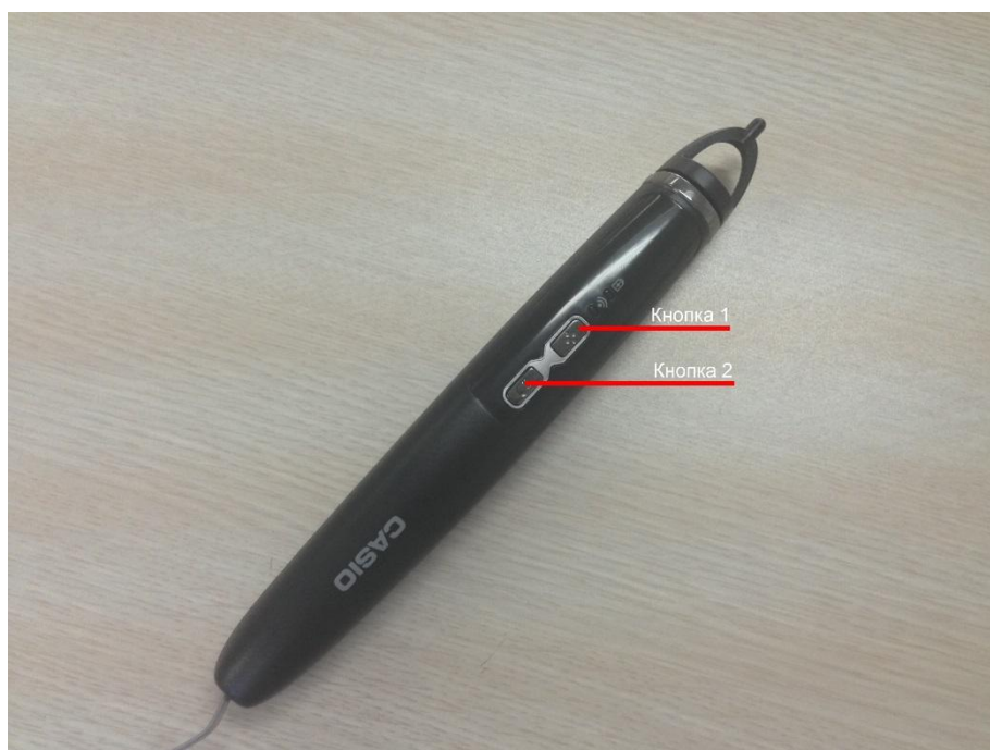
Рисунок 16. Кнопки электронного указателя.
